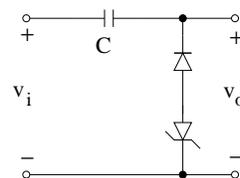
$$v_o = v_i + (V^- - V_{D0} - v_Z)$$
