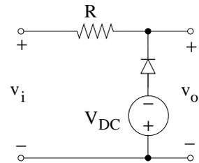
*Diode OFF:*  $i_D = 0$ ,  $v_D < V_{D0}$ :
