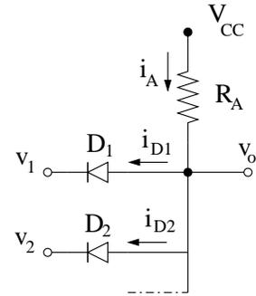
Case 1,  $v_1 = v_2 = 0$ :
