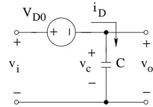
*Diode OFF:*  $i_D = 0$ ,  $v_D < V_{D0}$ :
